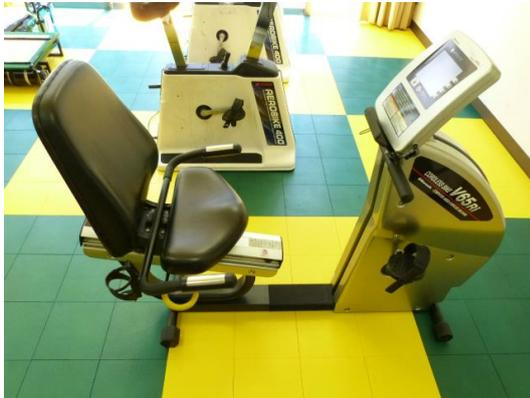
有酸素運動に使用するトレーニング機器の一種。車輪のない自転車のような構造になっており、同じ位置にしながらペダルをこぐことができる。
